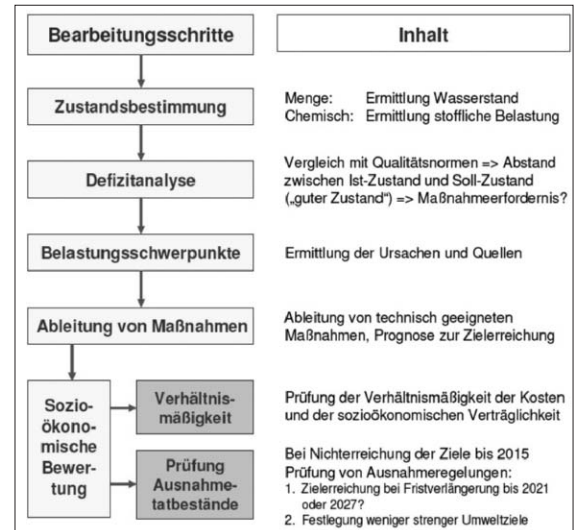
Abbildung 2: Bearbeitungsschritte zur Umsetzung der EU-WRRL gemäß Leitfaden zur Umweltzielbestimmung des Landes Sachsen-Anhalt
