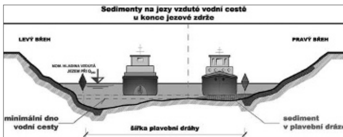
Obr.2. Příčný řez jezy vzdutou vodní cestou
