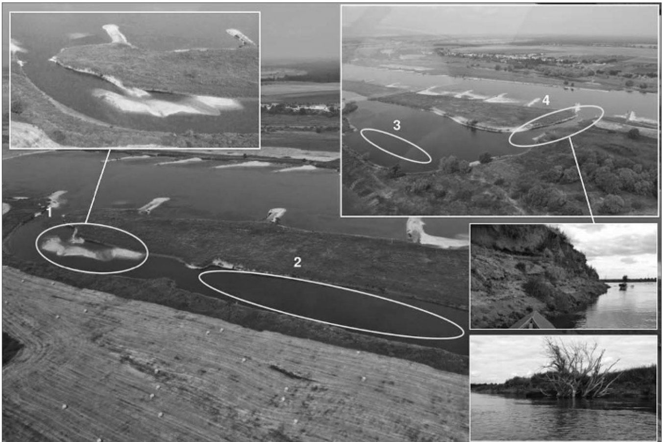
Abb. 1. Morphodynamischer Zustand und erkennbare Strukturen im beidseitig angeschlossenen Baggerloch Parchau – Zustrombereich und Mittelteil großes Foto, Ablaufbereich kleines Foto, Quelle Luftbilder: Tanja Pottgiesser, UBE
