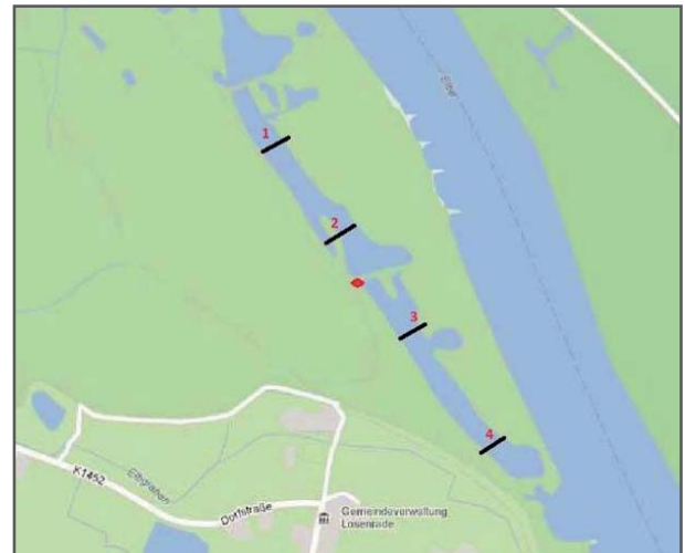
Abb. B-A2-7-4: Aufnahme der Sedimentauflagen in Querschnitten in den Seitenstrukturen bei Losenrade (Heise 2013)
