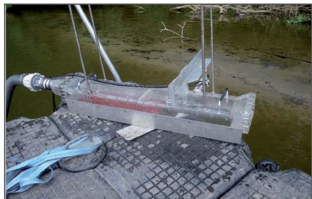
Abb. B-A2-8-3: Längsgerinne der Universität Stuttgart zur In-situ-Erfassung der kritischen Sohlschubspannung für Erosion (Quelle: IWS 2013a)
