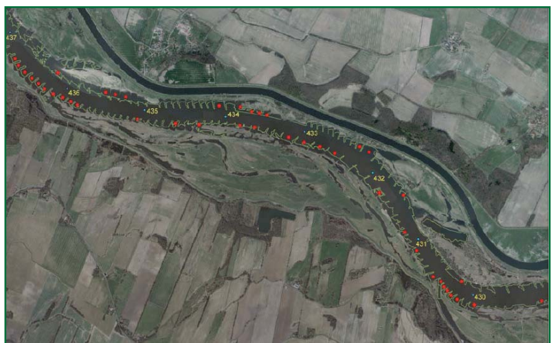
Abb. 6-7b: Beispiel einer regionalen Häufung von Bühnenfeldern, für die relevante Feinsedimentgehalte modelliert wurden (Quelle: BfG)
