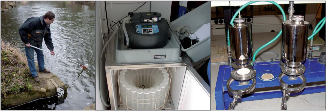
Abb. B-A2-2-1a: Probenahme- und Untersuchungsmethoden: manuelle Probenahme, automatischer Probenehmer ISCO, Druckfiltration (von links) – Fotos: J. Haliřová, ČHMÚ
