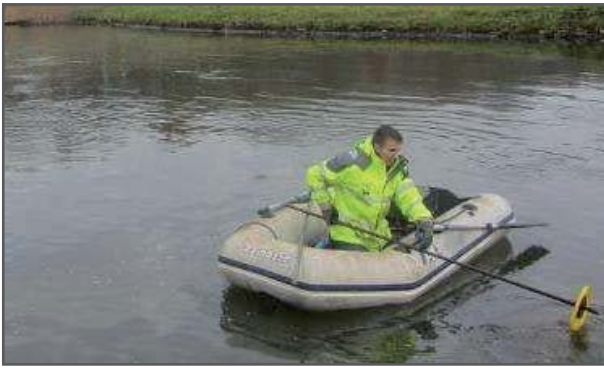
Abb. B-A2-7-8: Bestimmung der Sedimentmächtigkeit (Foto: LHW)
