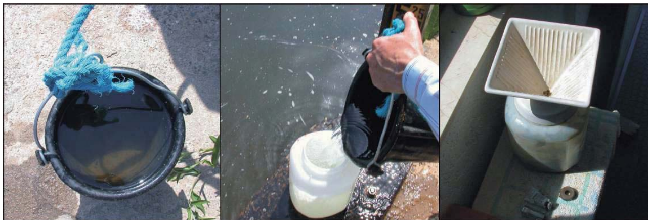
Abb. B-A2-2-1b: Probennahmeverfahren. Probenahmeimer (5 l), Abfüllen der Probe in ein Plastikgefäß (Sonderproben) und der genormte Keramikfilter für die Filtration vor Ort (von links) – Fotos: I. Quick, BfG
