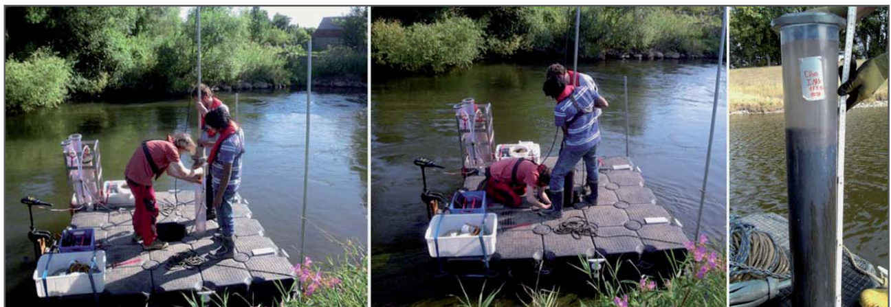
Abb. B-A2-8-4: Entnahme von Sedimentkernen für die Ermittlung der Erosionsstabilität im Tiefenprofil sowie für die Ermittlung von Zusatzparametern wie Korngrößenverteilung und Lagerungsdichte im Tiefenprofil (Quelle: IWS 2013a)
