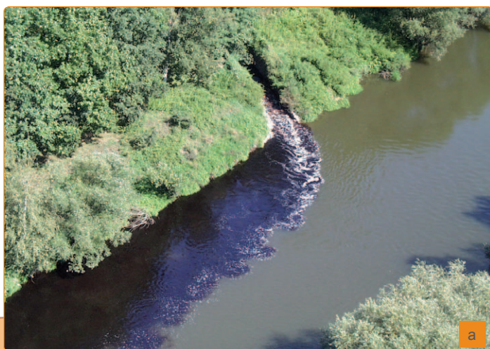
Abb. 8: Quellen für Sedimentkontaminationen im Flussgebiet a – Abwassereinleitung aus der chemischen Industrie in die Elbe unterhalb von Pardubice; b – Einlauf des Rothschönberger Stollens in die Triebisch
